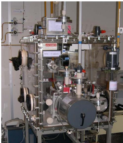
Figure 2 : Boîte à gants anoxique utilisée pour la préparation des synthèses
