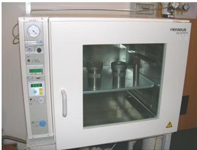
Figure 3 : Etuve anoxique sous argon utilisée pour le traitement thermique des enceintes de digestion
