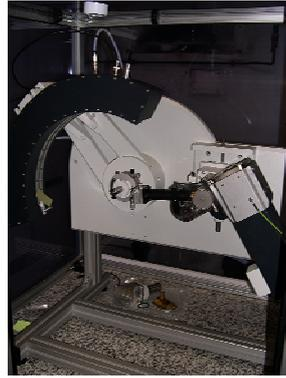
Figure 12 : Diffractomètre INEL possédant un détecteur courbe.
